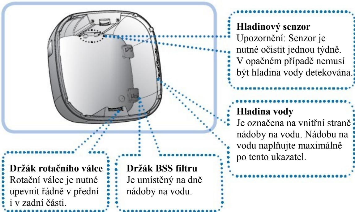
**Držák rotačního válce**
